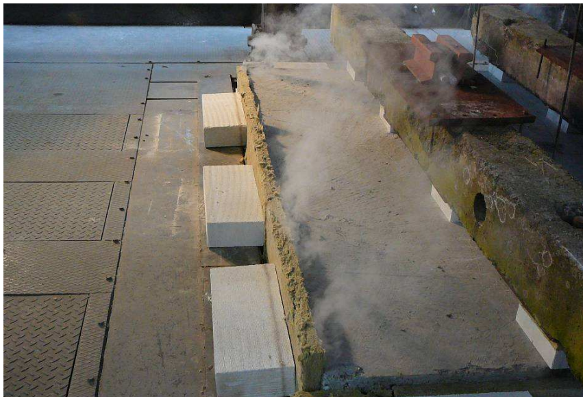
30. minuta zkoušky - bílý dým ma okrajích vzorku
