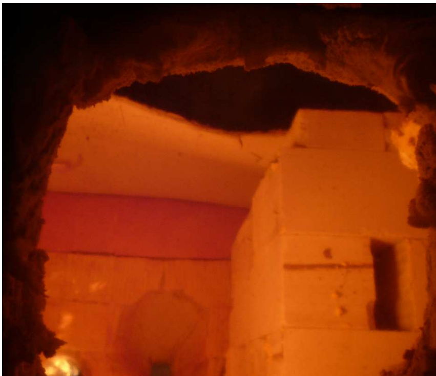
45. minuta zkoušky - na ES vzorku odpadla celá plocha omítky.
